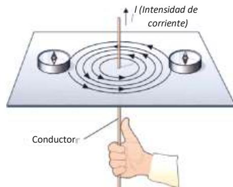
para ser detectado por las limaduras de hierro o cualquier otro material magnético que se coloque en la superficie formando círculos concéntricos con el alambre.
