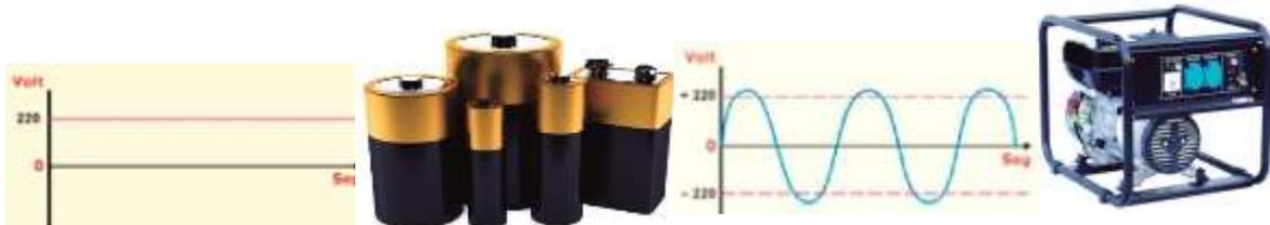
La *corriente alterna* es aquella en que *el flujo de cargas se mueve alternadamente* dentro del conductor, desplazándose en un sentido y otro; es decir, las cargas "van y vuelven" constantemente. Este tipo de corriente es producido por *generadores eléctricos*.
