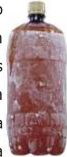
Sobre  $4^{\circ}$  predomina la expansión térmica con la consiguiente disminución de la densidad. Las variaciones de densidad con la temperatura tienen una profunda repercusión en el medio ambiente. Este comportamiento térmico poco común del agua, se puede utilizar para explicar por qué un lago se congela lentamente de arriba hacia abajo. El agua a  $4^{\circ}$ , que es más densa, se sumerge hasta el fondo, mientras que el agua sobre  $4^{\circ}\text{C}$ , sube a la parte superior.
